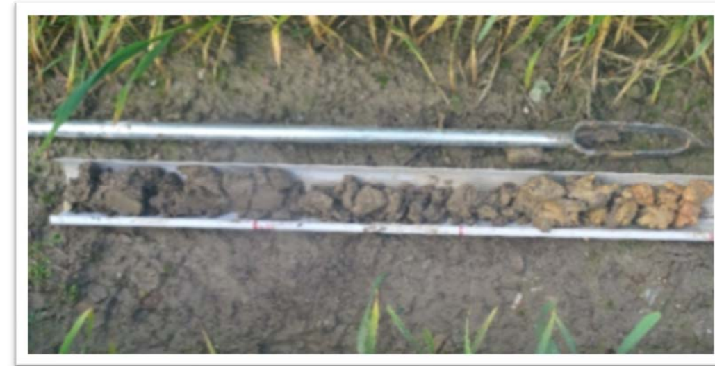
Photo 1 - Exemple de carottage sur une profondeur de 120 cm
